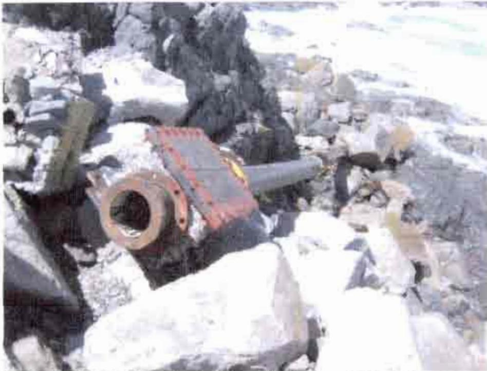
Fotografía N° 29 Sección de filtro y ducto apostada entre las rocas.
