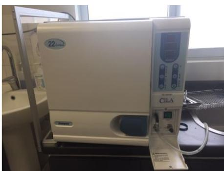
**AUTOCLAVE AUTOMÁTICO CLASE B EUROPEA DE 23 LITROS**: Equipo para esterilizar por vapor que consiste en un recipiente cilíndrico, de paredes metálicas y con cierre hermético.
